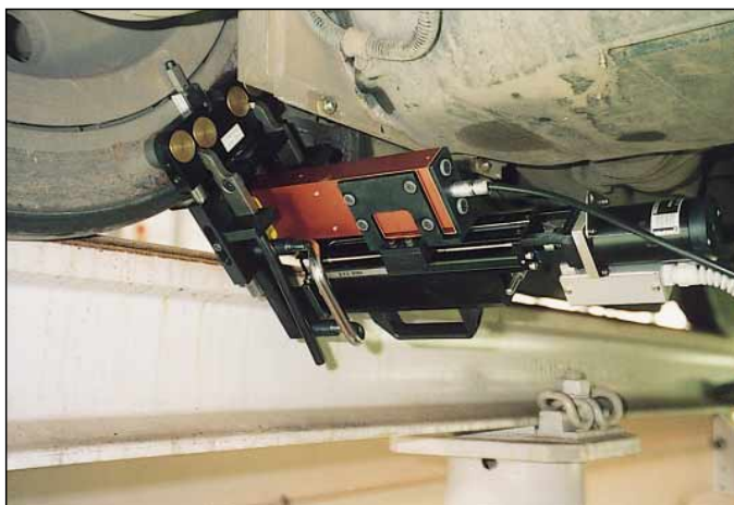
Abb. 4: Mobiles Laser-Radprofilmessgerät (Radinnenseite)
