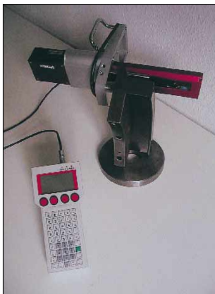
Abb. 3: Batteriebetriebenes, mobiles Laser-Radprofilmessgerät mit Datalogger
