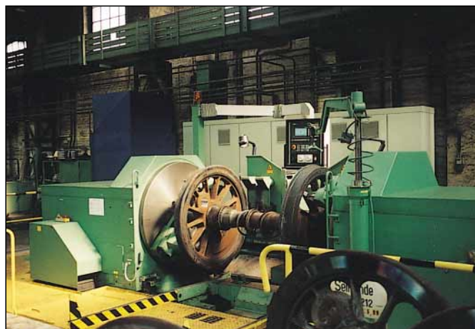
Abb. 1: Radsatzdrehmaschine mit Lasermesseinrichtung
