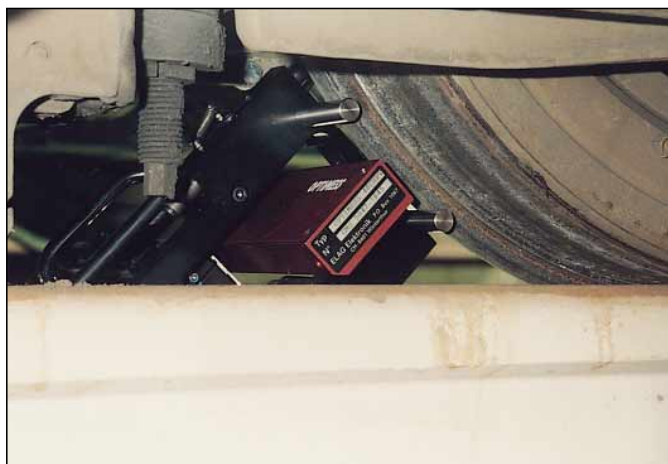
Abb. 5: Mobiles Laser-Radprofilmessgerät (Radaußenseite)
