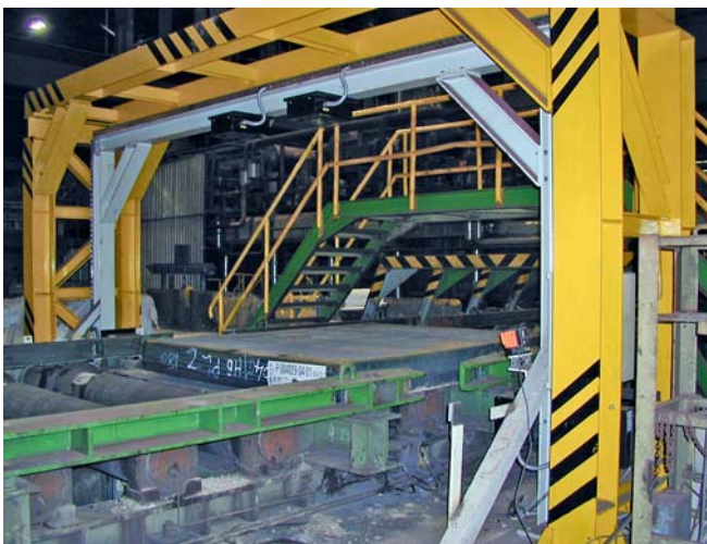
Bild 3. Dicken- und Breitenmessung von Stahlbrammen mit Lasertriangulationsscannern
