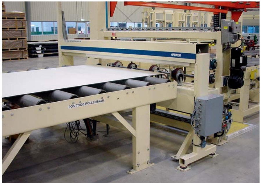
Bild 2. Anlage zur mehrspurigen Dickenmessung von Fassadenplatten
