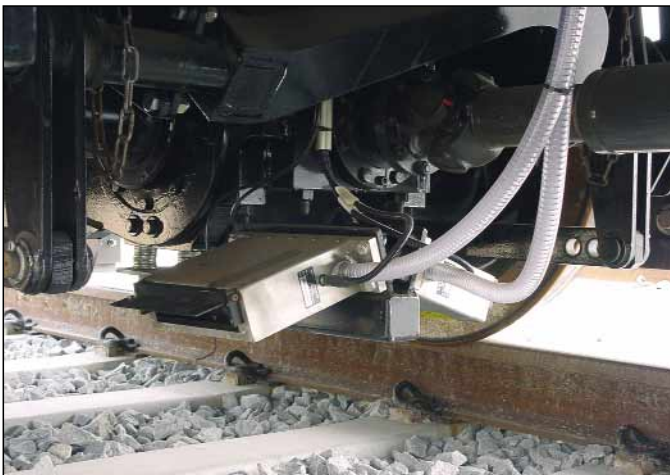
Abb. 6: Impulsgeber Lasersensor OPTImess zur Spurweitenmessung
