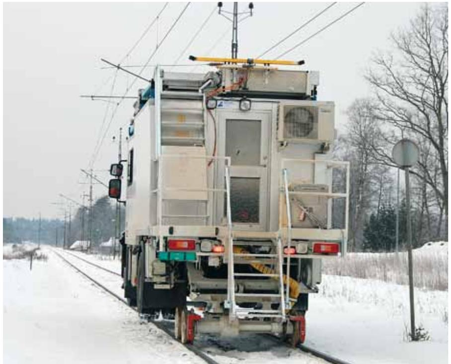
»OVHWizard« ist ein berührungslos arbeitendes Fahrdrahtmess-System von Dr. Wehrhahn. Montiert werden kann es beispielsweise auf einem Zweibege-Fahrzeug.
