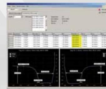
Die datenbankgestützte Software ermöglicht die weiterführende Auswertung der am Fahrzeug aufgenommenen Profil- und Durchmesserdaten. Gleichzeitig ermöglicht sie die Verwaltung aller Fahrzeuge und Radsätze. Neben den ermittelten Kennwerten des Profils steht die komplette Profilkurve für weiterführende Verschleißuntersuchungen zur Verfügung. Eine Weitergabe aller Daten an ein übergeordnetes System (z.B. SAP) ist möglich.
