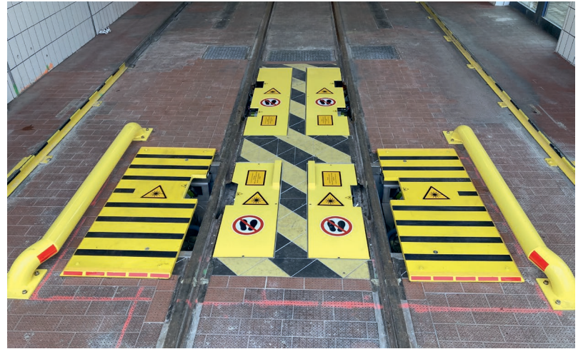
»IWMS« Outdoor-Messanlage in der Waschanlage mit Lkw-Überfahrmöglichkeit. Bild: Stadtwerke Augsburg
